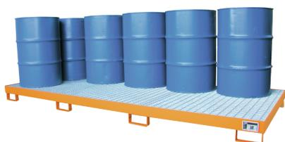
Maße: ca. 3280 x 1300 x 200 (L x B x H in mm), Auffangvolumen: 280 l Farbe RAL 5012 blau, Materialstärke 3 mm, mit verzinktem, herausnehmbarem Gitterrost (3-teilig), Einfahrbügel 100 mm Unterfahrhöhe, geeignet für brennbare Flüssigkeiten F+, F und wassergefährdende Flüssigkeiten WGK 1 - 3. Prüfungen: Übereinstimmungserklärung (ÜHP) nach StawaR, TÜV-GEPRÜFT
