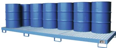
Maße: ca. 3880 x 1300 x 200 (L x B x H in mm), Auffangvolumen: 335 l Farbe RAL 5012 blau, Materialstärke 3 mm, mit verzinktem, herausnehmbarem Gitterrost (3-teilig), Einfahrbügel 100 mm Unterfahrhöhe, geeignet für brennbare Flüssigkeiten F+, F und wassergefährdende Flüssigkeiten WGK 1 - 3. Prüfungen: Übereinstimmungserklärung (ÜHP) nach StawaR, TÜV-GEPRÜFT
