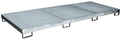
Maße: ca. 3280 x 1300 x 200 (L x B x H in mm), Auffangvolumen: 280 l Materialstärke 3 mm, mit verzinktem, herausnehmbarem Gitterrost (3-teilig), Einfahrbügel 100 mm Unterfahrhöhe, geeignet für brennbare Flüssigkeiten F+, F und wassergefährdende Flüssigkeiten WGK 1 - 3. Prüfungen: Übereinstimmungserklärung (ÜHP) nach StawaR, TÜV-GEPRÜFT
