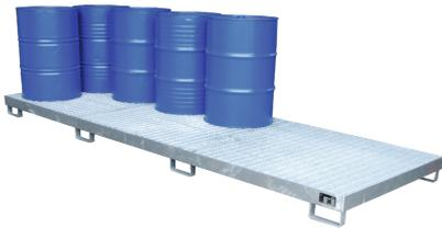
Maße: ca. 3880 x 1300 x 200 (L x B x H in mm), Auffangvolumen: 335 l Materialstärke 3 mm, mit verzinktem, herausnehmbarem Gitterrost (3-teilig), Einfahrbügel 100 mm Unterfahrhöhe, geeignet für brennbare Flüssigkeiten F+, F und wassergefährdende Flüssigkeiten WGK 1 - 3. Prüfungen: Übereinstimmungserklärung (ÜHP) nach StawaR, TÜV-GEPRÜFT
