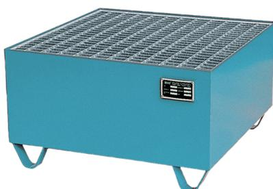
Maße: ca. 800 x 800 x 465 (B x T x H in mm), Auffangvolumen: 210 l Farbe RAL 5012 blau, Materialstärke 3 mm, mit verzinktem, herausnehmbarem Gitterrost, Stellkufen 100 mm Unterfahrhöhe, Belastung: 250 kg, geeignet für brennbare Flüssigkeiten F+, F und wassergefährdende Flüssigkeiten WGK 1 - 3. Prüfungen: Übereinstimmungserklärung (ÜHP) nach StawaR, TÜV-GEPRÜFT
