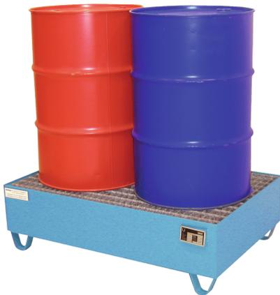
Maße: ca. 1200 x 800 x 360 (B x T x H in mm), Auffangvolumen: 200 l Farbe RAL 5012 blau, Materialstärke 3 mm, mit verzinktem, herausnehmbarem Gitterrost, Stellkufen 100 mm Unterfahrhöhe, Belastung: 500 kg, geeignet für brennbare Flüssigkeiten F+, F und wassergefährdende Flüssigkeiten WGK 1 - 3. Prüfungen: Übereinstimmungserklärung (ÜHP) nach StawaR, TÜV-GEPRÜFT
