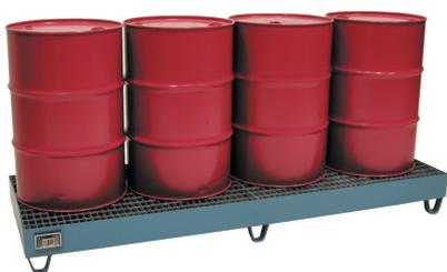
Maße: ca. 2400 x 800 x 250 (B x T x H in mm), Auffangvolumen: 210 l Farbe RAL 5012 blau, Materialstärke 3 mm, mit verzinktem, herausnehmbarem Gitterrost, Stellkufen 100 mm Unterfahrhöhe, Belastung: 1000 kg, geeignet für brennbare Flüssigkeiten F+, F und wassergefährdende Flüssigkeiten WGK 1 - 3. Prüfungen: Übereinstimmungserklärung (ÜHP) nach StawaR, TÜV-GEPRÜFT
