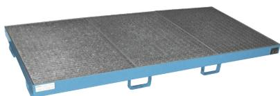
Maße: ca. 2700 x 1300 x 205 (B x T x H in mm), Auffangvolumen: 210 l Farbe RAL 5012 blau, Materialstärke 3 mm, mit verzinktem, herausnehmbarem Gitterrost, Stellkufen 100 mm Unterfahrhöhe, Belastung: 1600 kg, geeignet für brennbare Flüssigkeiten F+, F und wassergefährdende Flüssigkeiten WGK 1 - 3. Prüfungen: Übereinstimmungserklärung (ÜHP) nach StawaR, TÜV-GEPRÜFT
