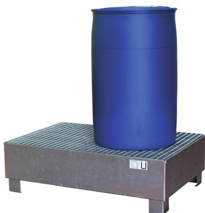
Maße: ca. 1200 x 800 x 360 (B x T x H in mm), Auffangvolumen: 210 l Materialstärke 3 mm, mit verzinktem, herausnehmbarem Gitterrost, Stellkufen 100 mm Unterfahrhöhe, Belastung: 500 kg, geeignet für brennbare Flüssigkeiten F+, F und wassergefährdende Flüssigkeiten WGK 1 - 3. Prüfungen: Übereinstimmungserklärung (ÜHP) nach StawaR
