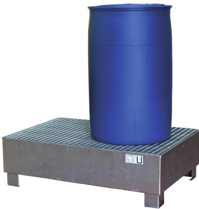
Maße: ca. 1200 x 800 x 360 (B x T x H in mm), Auffangvolumen: 210 l Materialstärke 3 mm, mit verzinktem, herausnehmbarem Gitterrost, Stellkufen 100 mm Unterfahrhöhe, Belastung: 500 kg, geeignet für brennbare Flüssigkeiten F+, F und wassergefährdende Flüssigkeiten WGK 1 - 3.
