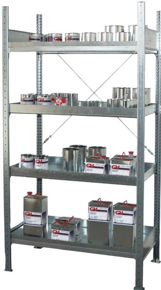
mit 4 Wannenhöden, Maße: ca. 1000 x 600 x 2000 (B x T x H in mm), Auffangvolumen: 4 x 30 l, geeignet für brennbare Flüssigkeiten F+, F und wassergefährdende Flüssigkeiten WGK 1 - 3, Regalständer und Wannenhöden verzinkt, höhenverstellbar im Raster von 25 mm, Tragfähigkeit je Boden 150 kg bei gleichmäßig verteilter Last, Regal im Stecksystem zur Selbstmontage. Prüfungen: Auffangwannen mit Übereinstimmungserklärung (ÜHP) nach StawaR, DLG-FOKUS-TEST, TÜV-GEPRÜFT
