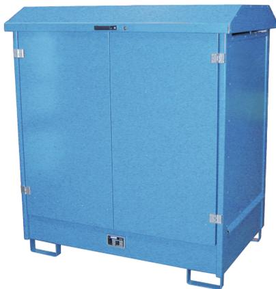
für 2 x 200 l-Fass, Maße: ca. 1437 x 1015 x 1614 (L x B x H in mm), Auffangvolumen: 210 l, Außenlackierung RAL 5012 blau, mit natürlichem Luftwechsel, Auffangwanne mit verzinktem Gitterrost, Dach mit Gasdruckfedern, abschließbar, Einfahrtaschen mit 100 mm Unterfahrhöhe, geeignet für brennbare Flüssigkeiten F+, F und wassergefährdende Flüssigkeiten WGK 1 - 3. Prüfung: Allgemeine bauaufsichtliche Zulassung Z-38.5-101 des DIBt-Berlin, TÜV-GEPRÜFT
