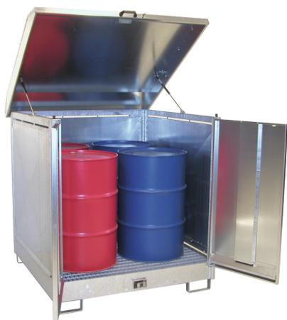
für 4 x 200 l-Fass, Maße: ca. 1437 x 1500 x 1557 (L x B x H in mm), Auffangvolumen: 220 l, mit natürlichem Luftwechsel, Auffangwanne mit verzinktem Gitterrost, Dach mit Gasdruckfedern, abschließbar, Einfahrtaschen mit 100 mm Unterfahrhöhe, geeignet für brennbare Flüssigkeiten F+, F und wassergefährdende Flüssigkeiten WGK 1 - 3. Prüfung: Allgemeine bauaufsichtliche Zulassung Z-38.5-101 des DIBt-Berlin, TÜV-GEPRÜFT
