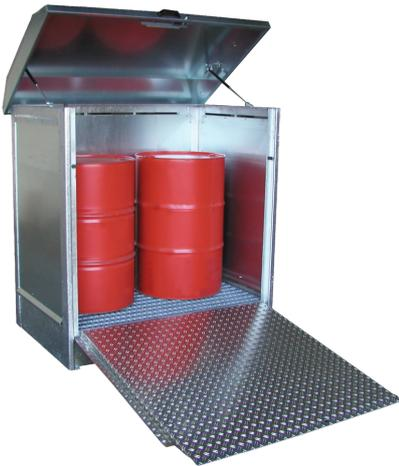
für 2 x 200 l-Fass, Maße: ca. 1437 x 1015 x 1514 (L x B x H in mm), Auffangvolumen: 210 l, mit natürlichem Luftwechsel, Auffangwanne mit verzinktem Gitterrost, Dach mit Gasdruckfedern, abschließbar, mit abklappbarer Vordertür aus Aluminium als Auffahrrampe, geeignet für brennbare Flüssigkeiten F+, F und wassergefährdende Flüssigkeiten WGK 1 - 3. Prüfung: Allgemeine bauaufsichtliche Zulassung Z-38.5-101 des DIBt-Berlin, TÜV-GEPRÜFT
