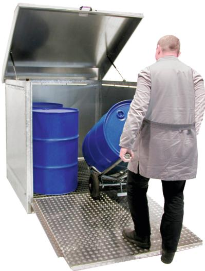
für 4 x 200 l-Fass, Maße: ca. 1437 x 1500 x 1457 (L x B x H in mm), Auffangvolumen: 220 l, mit natürlichem Luftwechsel, Auffangwanne mit verzinktem Gitterrost, Dach mit Gasdruckfedern, abschließbar, mit abklappbarer Vordertür aus Aluminium als Auffahrrampe, geeignet für brennbare Flüssigkeiten F+, F und wassergefährdende Flüssigkeiten WGK 1 - 3. Prüfung: Allgemeine bauaufsichtliche Zulassung Z-38.5-101 des DIBt-Berlin, TÜV-GEPRÜFT
