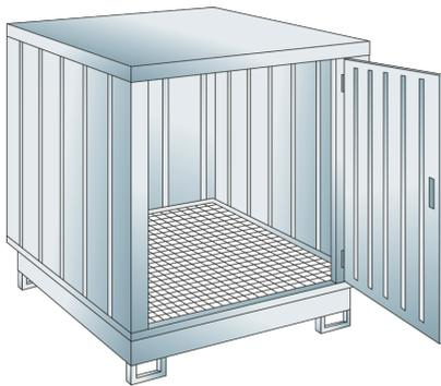
Stahlblech verzinkt Maße: ca. 1250 x 1525 x 1699 (L x B x H in mm) Kapazität: 2500 l Zugelassen für die Lagerung von wassergefährdenden Flüssigkeiten WGK 1 - 3, brennbaren Flüssigkeiten, F+, F und entzündlichen, im Freien o. in Gebäuden unter Beachtung der spezifischen Brandschutzbestimmungen. Containeraufbau:
