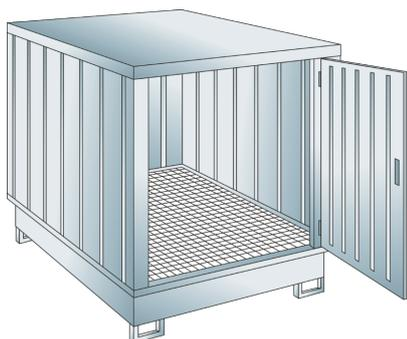
Stahlblech verzinkt Maße: ca. 1550 x 1525 x 1669 (L x B x H in mm) Kapazität: 2400 l Zugelassen für die Lagerung von wassergefährdenden Flüssigkeiten WGK 1 - 3, brennbaren Flüssigkeiten, F+, F und entzündlichen, im Freien o. in Gebäuden unter Beachtung der spezifischen Brandschutzbestimmungen. Containeraufbau:
