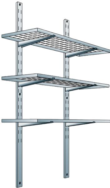
Maße: ca. 1000 x 500 (B x T in mm) bestehend aus: 2 Regalständer 6 Regalkonsolen (alle 140 mm verstellbar) 3 Gitterrostböden Belastung: 120 kg pro Gitterrostboden bei gleichmäßig verteilter Last
