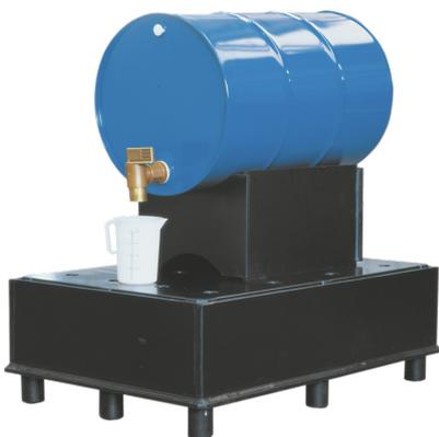
Maße: ca. 1270 x 870 x 400 (B x T x H in mm), Auffangvolumen: 225 l, Tragfähigkeit: 900 kg, geringes Eigengewicht: 62 kg, geschweißte Kunststoffkonstruktion aus extrudiertem Plattenmaterial (PE-HD), mit stabiler PE-Lochplatte als Stellebene, durch Fußkonstruktion 100 mm Unterfahrhöhe, geeignet für wassergefährdende, nichtbrennbare Flüssigkeiten WGK 1 - 3. Prüfung: Allgemeine bauaufsichtliche Zulassung des DIBt-Berlin, MPA-GEPRÜFT, TÜV-GEPRÜFT
