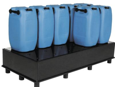
Maße: ca. 1870 x 870 x 310 (B x T x H in mm), Auffangvolumen: 225 l, Tragfähigkeit: 1350 kg, geringes Eigengewicht: 77 kg, geschweißte Kunststoffkonstruktion aus extrudiertem Plattenmaterial (PE-HD), mit stabiler PE-Lochplatte als Stellebene, durch Fußkonstruktion 100 mm Unterfahrhöhe, geeignet für wassergefährdende, nichtbrennbare Flüssigkeiten WGK 1 - 3. Prüfung: Allgemeine bauaufsichtliche Zulassung des DIBt-Berlin, MPA-geprüft, TÜV-geprüft
