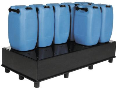
Maße: ca. 1870 x 870 x 310 (B x T x H in mm), Auffangvolumen: 225 l, Tragfähigkeit: 1350 kg, geringes Eigengewicht: 77 kg, geschweißte Kunststoffkonstruktion aus extrudiertem Plattenmaterial (PE-HD), mit stabiler PE-Lochplatte als Stellebene, durch Fußkonstruktion 100 mm Unterfahrhöhe, geeignet für wassergefährdende, nichtbrennbare Flüssigkeiten WGK 1 - 3. Prüfung: Allgemeine bauaufsichtliche Zulassung des DIBt-Berlin, MPA-geprüft, TÜV-geprüft
