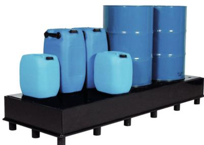
Maße: ca. 2470 x 870 x 270 (B x T x H in mm), Auffangvolumen: 225 l, Tragfähigkeit: 1800 kg, geringes Eigengewicht: 89 kg, geschweißte Kunststoffkonstruktion aus extrudiertem Plattenmaterial (PE-HD), mit stabiler PE-Lochplatte als Stellebene, durch Fußkonstruktion 100 mm Unterfahrhöhe, geeignet für wassergefährdende, nichtbrennbare Flüssigkeiten WGK 1 - 3. Prüfung: Allgemeine bauaufsichtliche Zulassung des DIBt-Berlin, MPA-geprüft, TÜV-geprüft
