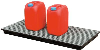
für Kleingebinde, Maße: ca. 1300 x 620 x 80 (L x B x H in mm), Tragfähigkeit: 50 kg, geringes Eigengewicht: 13 kg, mit verzinktem Stahlgitterrost, geeignet für wassergefährdende, nichtbrennbare Flüssigkeiten WGK 1 - 3. Prüfung: Allgemeine bauaufsichtliche Zulassung Z-40.22-388 des DIBt-Berlin
