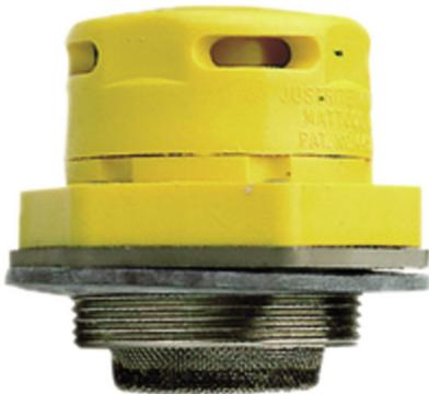
2 "-Gewinde, mit Flamm Sperre aus verzinktem Stahl, automatischer Überdruckausgleich, automatischer Vakuumausgleich, für die Fass-Rundseite.
