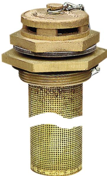
mit Flamsperre aus Messing, 140 mm lang, Kopfteil abschraubbar, automatischer Überdruckausgleich, automatischer Vakuumausgleich, für Fassrundseite.
