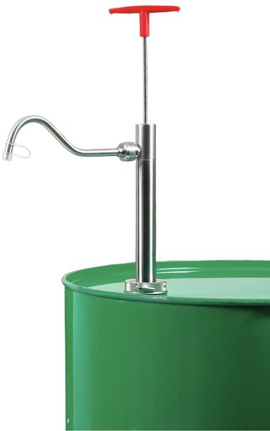
mediumberührte Teile aus Edelstahl 1.4301 und PTFE, elektrostatisch leitfähig, Auslaufbogen abschraubbar. Eintauchtiefe: 910 mm Fördermenge pro Hub: 560 ml Gesamtlänge: 1.030 mm Tauchrohr-Durchmesser: 32 mm
