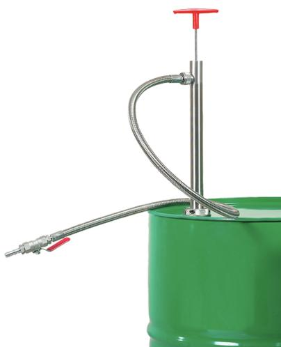
Absperrhahn und Auslauftülle, mediumberührte Teile aus Edelstahl 1.4301 und PTFE, elektrostatisch leitfähig, Auslaufschlauch abschraubbar. Eintauchtiefe: 910 mm Fördermenge pro Hub: 560 ml Gesamtlänge: 1.030 mm Tauchrohr-Durchmesser: 32 mm
