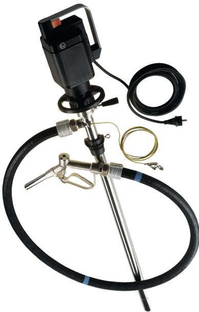
für leichtentzündliche Kohlenwasserstoffe, Fasspumpen-Set bestehend aus: Edelstahl-Fasspumpe, Restentleerungs-Pumpwerk aus Niro, 2 m Lösemittelschlauch DN 19, leitfähige Schlauchverbindungen, Potentialausgleichskabel, Messing-Zapfpistole und PP-Fassadapter, Schutzart IP 54, 230 V Motor mit 5 m Kabel und Schukostecker, ex-geschützt gemäß ATEX 100 a. Antrieb: Elektrisch Tauchtiefe: 1000 mm Tauchrohr-Durchmesser: 41 mm
