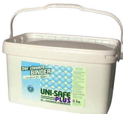
Feingranulat aus vernetzten Polymeren hergestellt, für alle Flüssigkeiten einsetzbar, nimmt bis zum 75-fachen des Eigengewichtes auf, sparsame und problemlose Dosierung, löst keine gefährlichen Reaktionen aus, auch bei Regen einsetzbar (pH-neutral), Bindersättigung durch Farbtintensivität sichtbar, Dammbildung möglich, quillt auf, verfügt über Indikatorfunktion - Farbumschlag Säuren (gelb) / Laugen (rot). Prüfungen: GEPRÜFT durch MPA NRW, Dortmund und Hygiene-Institut, Gelsenkirchen
