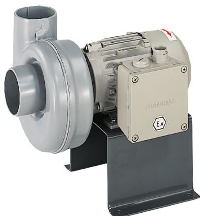
Explosionsschutzter, eigengekühlter Drehstrommotor, Anschluss DN 75, Spannung 400V, Frequenz 50Hz Schutzart: EExe T4 IP 54, PTB-Zulassung Konform nach: VDMA 24169/T1 Maschinenrichtlinie/EMV/CE
