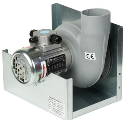
Eigengekühlter Wechselstrommotor Anschluss DN 75 Spannung 230 V, Frequenz 50/60Hz Konform nach: VDMA 24169/T1 Maschinenrichtlinie/EMV/CE
