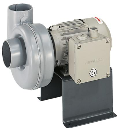
Explosiongeschützter, eigengekühlter Drehstrommotor, Anschluss DN 75, Schutzart EExe T4 IP 54, PTB Zulassung Konform nach: VDMA 24169/T1 Maschinenrichtlinie/EMV/CE
