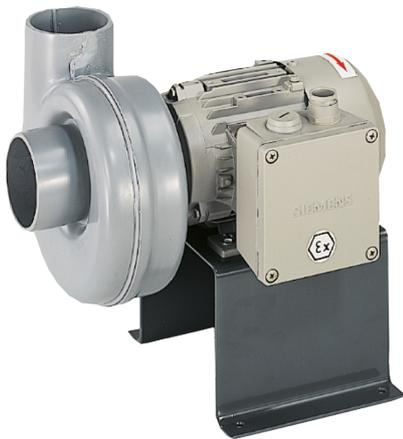
Explosiongeschützter, eigengekühlter Drehstrommotor, Anschluss DN 75, Spannung 400V, Frequenz 50Hz Schutzart: EExe II T4 IP 55, PTB Zulassung Konform nach: VDMA 24169/T1 Maschinenrichtlinie/EMV/CE
