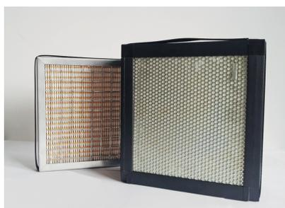
Bestehend aus Aktivkohle Austauschfilter 2.00.391\* und Partikelaustauschfilter 2.00.392\* Bei der Lagerung der beiden Filter ist darauf zu achten, dass diese trocken und sauber verschlossen im Polybeutel gelagert werden. Des Weiteren müssen die Filter vor Verschmutzung, Licht und Beschädigung geschützt gelagert werden. Unter diesen Bedingungen ist eine Lagerung über mehrere Jahre möglich. Beschädigte oder verschmutzte Filter sind nicht mehr einzusetzen.
