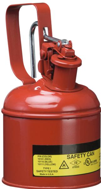
Maße: ca. 120 x 220 (D x H in mm) innen zinnbeschichtet, außen pulverbeschichtet - rot, Deckel selbstschließend, inkl. Edelstahl-Flammsperre im Behälterhals, automatischer Überdruckausgleich, Behälterkennzeichnung nach GefStoffV und BGV A8.
