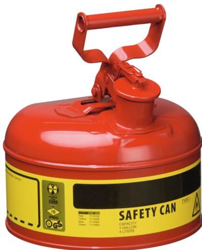
Maße: ca. 241 x 279 (D x H in mm) innen zinnbeschichtet, außen pulverbeschichtet - rot, Deckel selbstschließend, inkl. Edelstahl-Flammsperre im Behälterhals, automatischer Überdruckausgleich, Behälterkennzeichnung nach GefStoffV und BGV A8. Prüfungen: FM, UL, TÜV-GS
