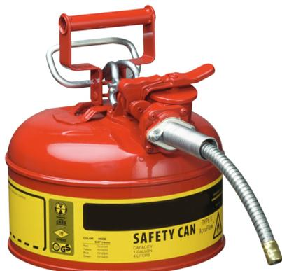
Stahlblech, innen zinnbeschichtet, außen pulverbeschichtet - rot, Deckel selbstschließend, Edelstahl-Flammsperre in Behälteröffnung, automatischer Überdruck-/Vakuumausgleich, Maße: ca. 241 x 267 (D x H in mm), verzinkter Metallschlauch, Länge: ca. 229 mm, Schlauchdurchmesser: ca. 16 mm, Behälterkennzeichnung nach GefStoffV und BGV A8. Prüfungen: FM, UL, TÜV-GS
