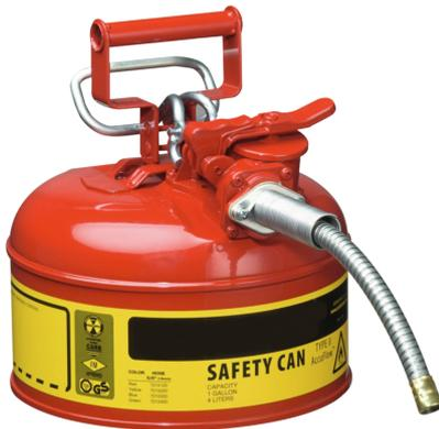
Stahlblech, innen zinnbeschichtet, außen pulverbeschichtet - rot, Deckel selbstschließend, Edelstahl-Flammsperre in Behälteröffnung, automatischer Überdruck-/Vakuumausgleich, Maße: ca. 241 x 267 (D x H in mm), verzinkter Metallschlauch, Länge: ca. 229 mm, Schlauchdurchmesser: ca. 16 mm, Behälterkennzeichnung nach GefStoffV und BGV A8. Prüfungen: FM, UL, TÜV-GS
