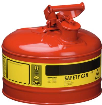
Maße: ca. 298 x 292 (D x H in mm) innen zinnbeschichtet, außen pulverbeschichtet - rot, Deckel selbstschließend, inkl. Edelstahl-Flammsperre im Behälterhals, automatischer Überdruckausgleich, Behälterkennzeichnung nach GefStoffV und BGV A8. Prüfungen: FM, UL, TÜV-GS
