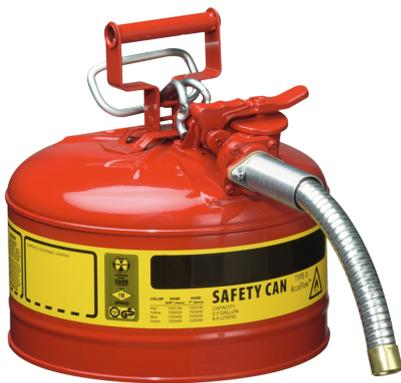
Stahlblech, innen zinnbeschichtet, außen pulverbeschichtet - rot, Deckel selbstschließend, Edelstahl-Flammsperre in Behälteröffnung, automatischer Überdruck-/Vakuumausgleich, Maße: ca. 298 x 305 (D x H in mm), verzinkter Metallschlauch, Länge: ca. 229 mm, Schlauchdurchmesser: ca. 25 mm, Behälterkennzeichnung nach GefStoffV und BGV A8. Prüfungen: FM, UL, TÜV-GS
