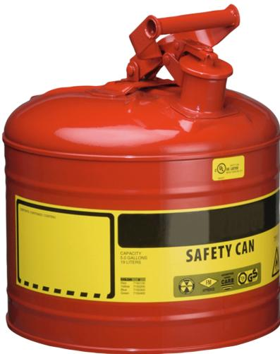
Maße: ca. 298 x 429 (D x H in mm) innen zinnbeschichtet, außen pulverbeschichtet - rot, Deckel selbstschließend, Edelstahl-Flammsperre im Behälterhals, automatischer Überdruckausgleich, Behälterkennzeichnung nach GefStoffV und BGV A8. Prüfungen: FM, UL, TÜV-GS
