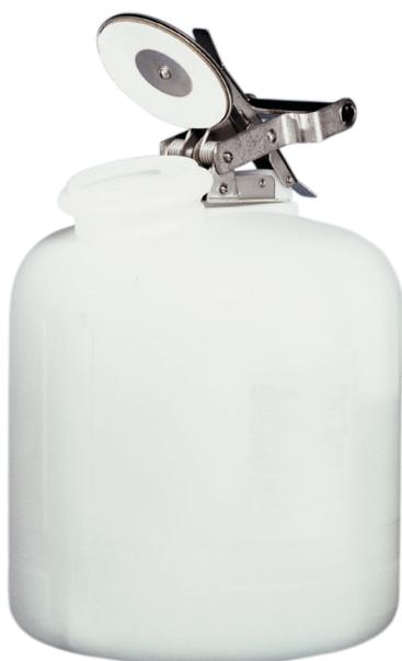
FÜR NICHTBRENNBARE FLÜSSIGKEITEN Maße: ca. 260 x 370 (D x H in mm) Deckel selbstschließend, ohne Flamm Sperre, Armaturen aus Edelstahl, automatischer Überdruckausgleich, Behälterkennzeichnung nach GefStoffV und BGV A8.
