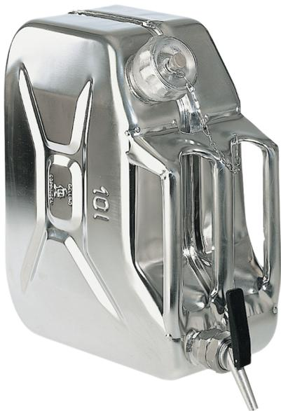
Edelstahl 1.4301 poliert Maße: ca. 175 x 350 x 300 (B x T x H in mm) 3/4 "-Anschluss f. optional erhältlichen Zapfhahn Flamm Sperre in Verschlusskappe, manueller Vakuum-/Überdruckausgleich im Verschlussdeckel, Behälterkennzeichnung nach GefStoffV und BGV A8.
