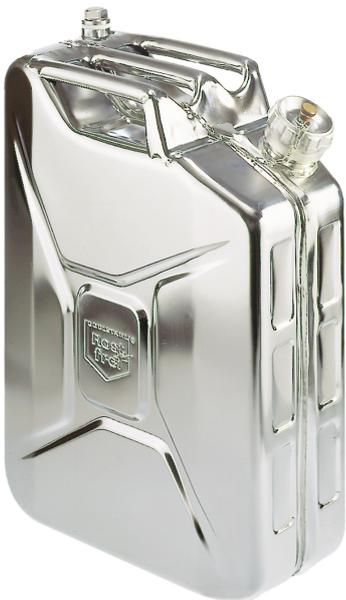
Edelstahl 1.4301 poliert Maße: ca. 175 x 350 x 490 (B x T x H in mm) 3/4 "-Anschluss f. optional erhältlichen Zapfhahn Flamm Sperre in Verschlusskappe, manueller Vakuum-/Überdruckausgleich im Verschlussdeckel, Behälterkennzeichnung nach GefStoffV und BGV A8.
