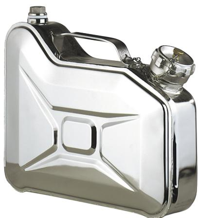
Edelstahl 1.4301 poliert Maße: ca. 105 x 350 x 300 (B x T x H in mm) 3/4 "-Anschluss f. optional erhältlichen Zapfhahn Flamm Sperre in Verschlusskappe, manueller Vakuum-/Überdruckausgleich im Verschlussdeckel, Behälterkennzeichnung nach GefStoffV und BGV A8.
