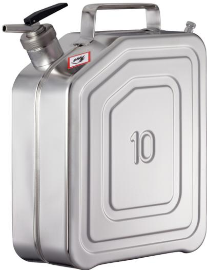
Edelstahl 1.4571 poliert Maße: ca. 130 x 280 x 370 (B x T x H in mm) Flamm Sperre im Behälterhals, incl. selbstschließender Abfüllhahn, manueller Überdruck-/Vakuumausgleich, Behälterkennzeichnung nach GefStoffV und BGV A8.
