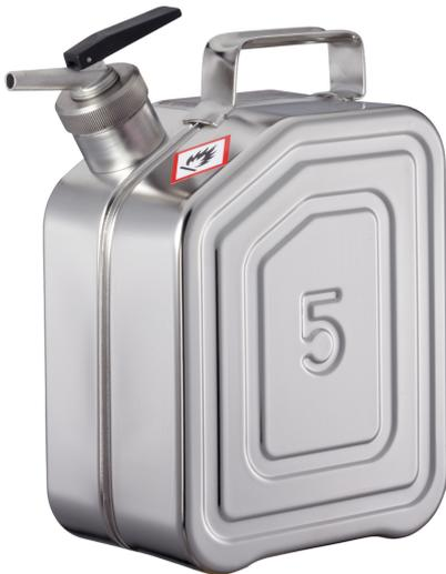
Edelstahl 1.4571 poliert Maße: ca. 130 x 210 x 310 (B x T x H in mm) Flamm Sperre im Behälterhals, selbstschließender Dosierhahn mit Belüftung, automatischer Überdruck-/Vakuumausgleich, Behälterkennzeichnung nach GefStoffV und BGV A8.
