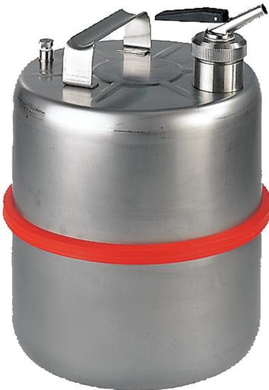
Edelstahl 1.4571 unpoliert Maße: ca. 260 x 340 (D x H in mm) Flamm Sperre im Behälterhals, selbstschließender Dosierhahn mit Belüftung, manueller Vakuum-/Überdruckausgleich, Behälterkennzeichnung nach GefStoffV und BGV A8.
