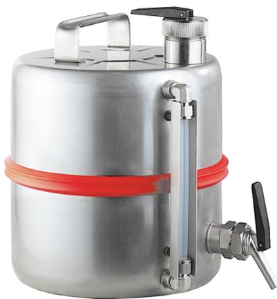
Edelstahl 1.4571 unpoliert Maße: ca. 260 x 330 (D x H in mm) Füllstandsanzeige aus PFA, Flamm Sperre im Behälterhals, selbstschließender Zapfhahn, manueller Vakuum-/Überdruckausgleich, Behälterkennzeichnung nach GefStoffV und BGV A8.
