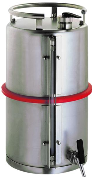
Edelstahl 1.4301 unpoliert Maße: ca. 300 x 530 (D x H in mm) mit umlaufendem Tragegriff, stapelbar, Füllstandsanzeige aus PFA, Flamm Sperre im Behälterhals, manueller Vakuum-/Überdruckausgleich in der Schraubkappe, Flamm Sperre in Einfüllöffnung, selbstschließender Zapfhahn, Behälterkennzeichnung nach GefStoffV und BGV A8.
